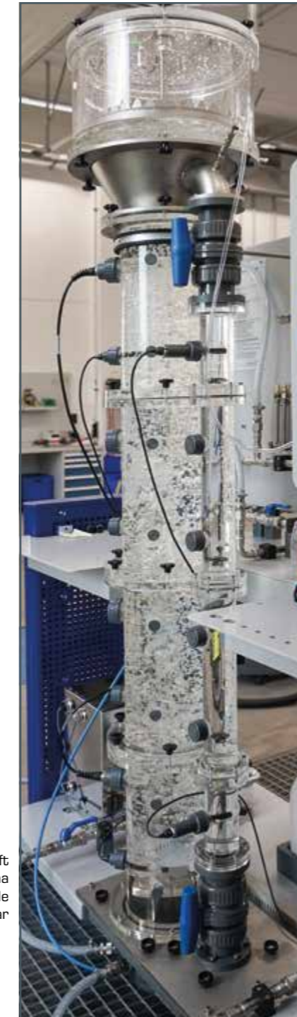
Varios distribuidores para la aeración del reactor
