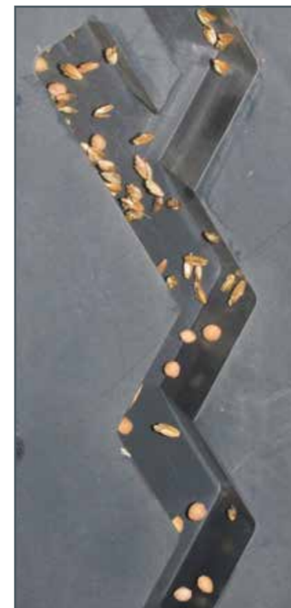
En el conducto de pliegues se puede observar con claridad la separación de la mezcla.
