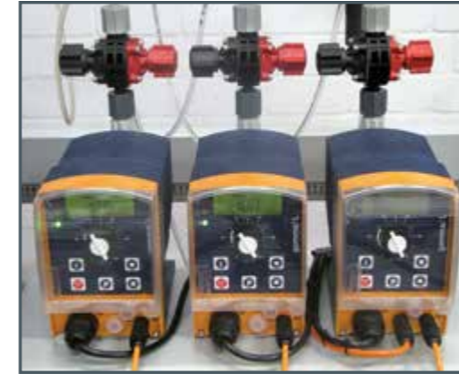
De serie en GUNT: uso de componentes industriales de alta calidad como, p. ej., bombas dosificadoras profesionales
