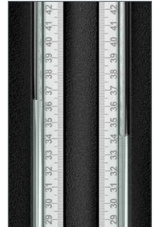
El manómetro de tubos permite determinar pérdidas de carga bajas con un alto grado de precisión.
