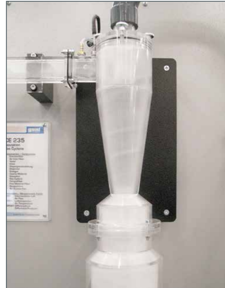
Separación de polvo fino de cuarzo en el ciclón de gas durante el funcionamiento de prueba en nuestro laboratorio. Se reconoce el movimiento en espiral de las partículas característico de los ciclones.
