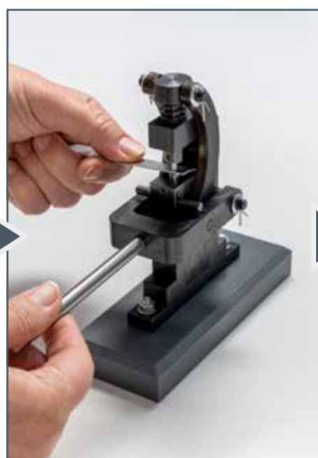
Punzonar agujeros con la prensa de palanca de TZ 300
