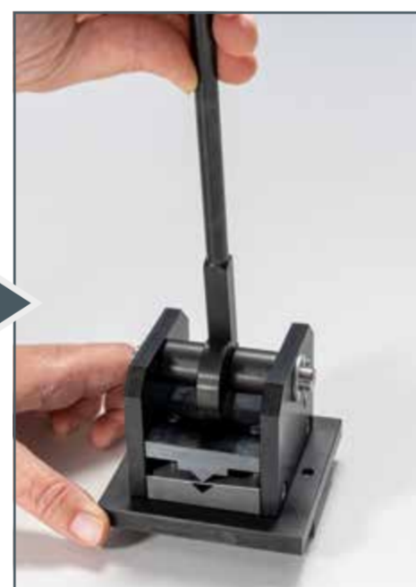
Formar la pieza de trabajo con la prensa de plegado de TZ 200.01
