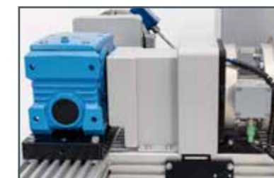
protección mecánica, eje de salida/acoplamiento, lado de carga
