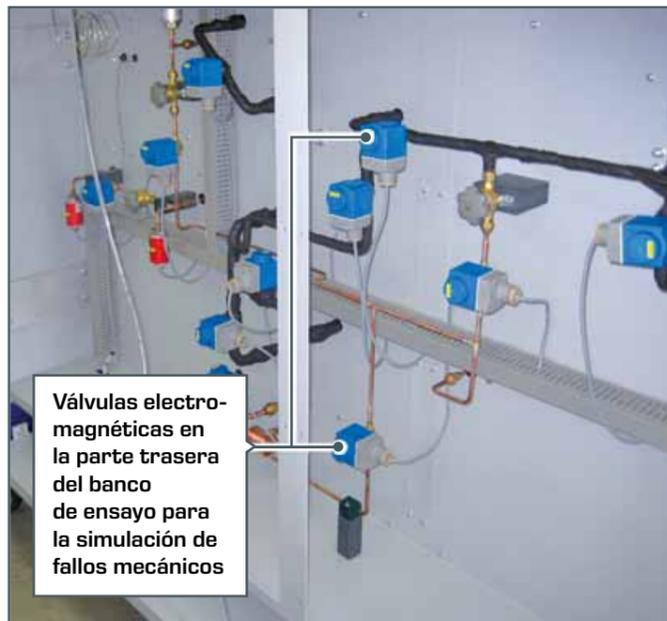
Válvulas electro-magnéticas en la parte trasera del banco de ensayo para la simulación de fallos mecánicos
