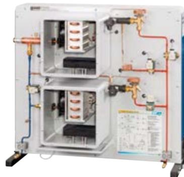
todos los kits de montaje contienen elementos de expansión y evaporadores
