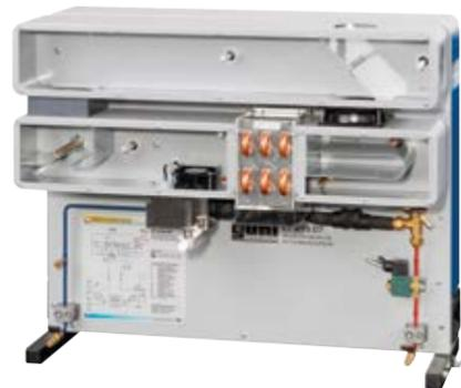
La unidad básica ET 915 contiene los componentes principales compresor y condensador
