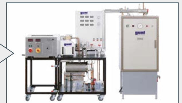
Central térmica de vapor con máquina de vapor de 2 cilindros y generador de vapor eléctrico
