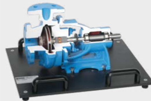
HM 700.17 Modelo seccionado: bomba centrífuga
