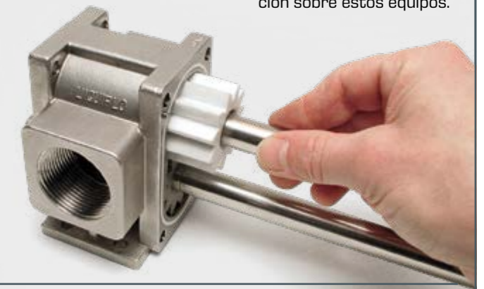
MT 186 Montaje y mantenimiento: bomba de engranajes
