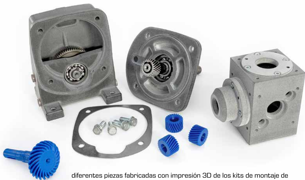
diferentes piezas fabricadas con impresión 3D de los kits de montaje de engranajes
