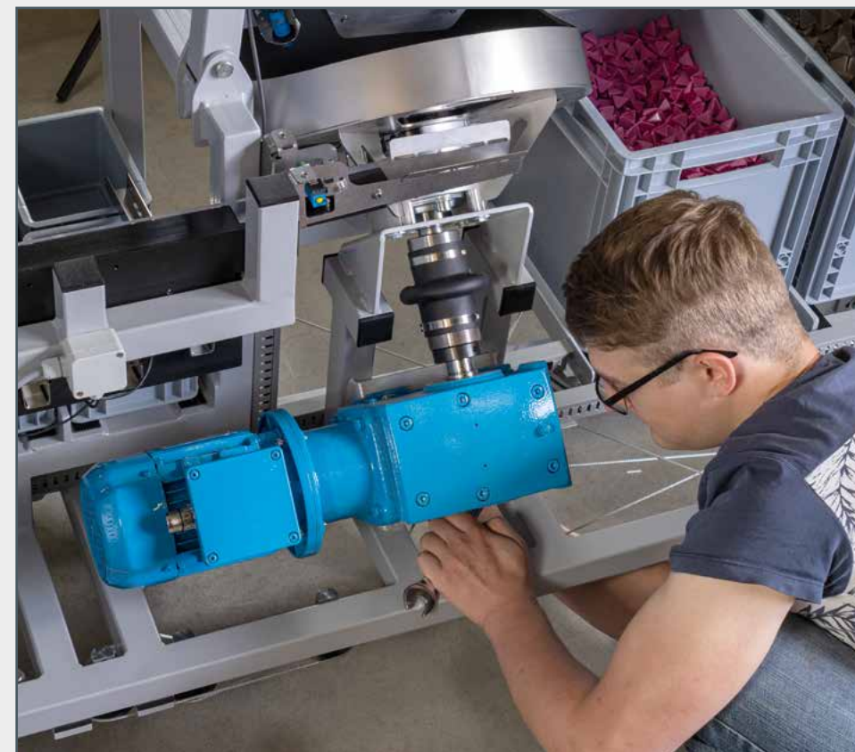
afloje la unión roscada entre la cadena de transmisión y el bastidor del MT174
