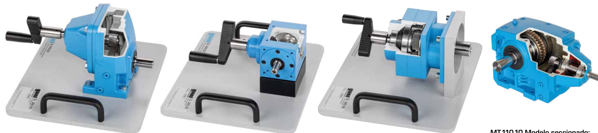
GL 300.03 Modelo seccionado: engranaje recto
