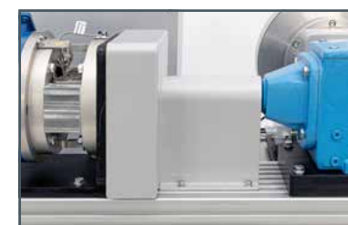
protección mecánica, eje de accionamiento/acoplamiento, lado de accionamiento
