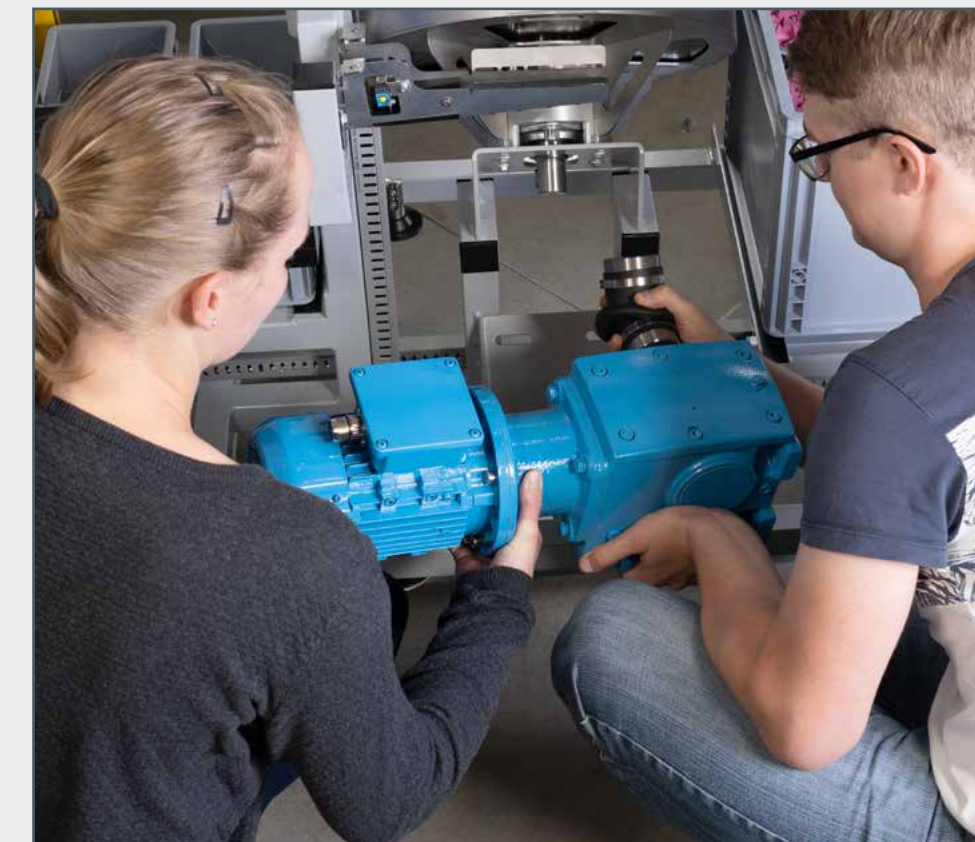
la cadena de transmisión se saca, la junta universal se suelta
