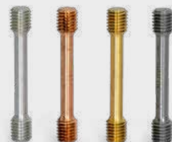
Probetas de tracción con sección circular según DIN 50125, material: Al, Cu, St, CuZn
