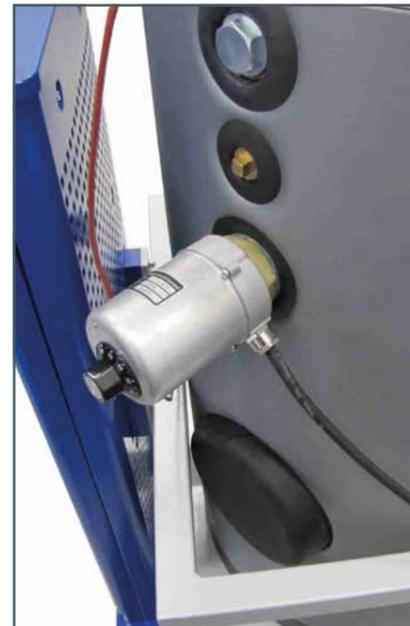
Zur Versuchsvorbereitung wird der Speicherbehälter entleert. Anschließend kann die Zusatzheizung mit wenigen Handgriffen leicht eingesetzt werden.
