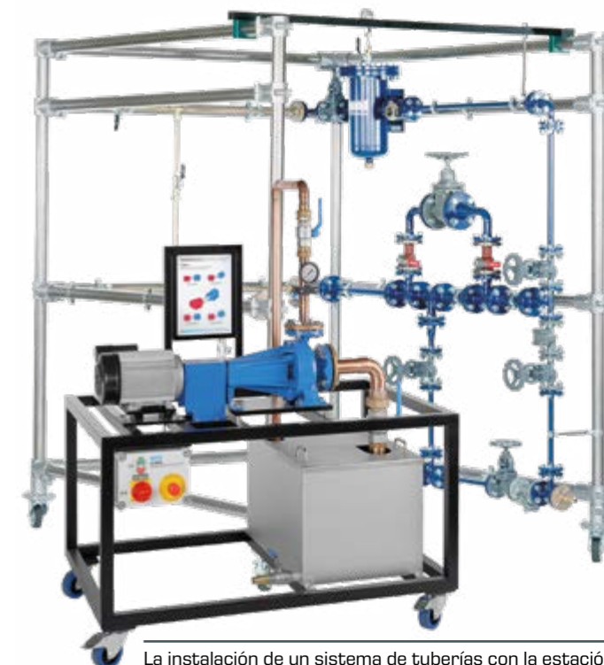
La instalación de un sistema de tuberías con la estación de montaje HL 960 y el banco de ensayos HL 960.01
