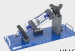
HM 250.05 Medición de fuerzas ejercidas por un chorro
