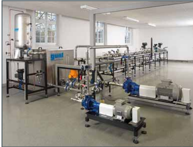
Planta de ensayo HM 124 en un laboratorio con sistema controlado de presión opcional mediante un depósito a presión
