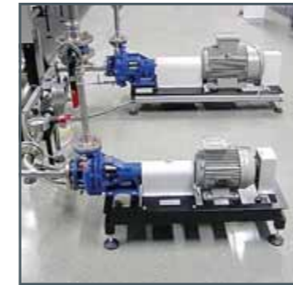
Para el estudio en bombas, hay dos bombas centrífugas disponibles de distintos tamaños.
