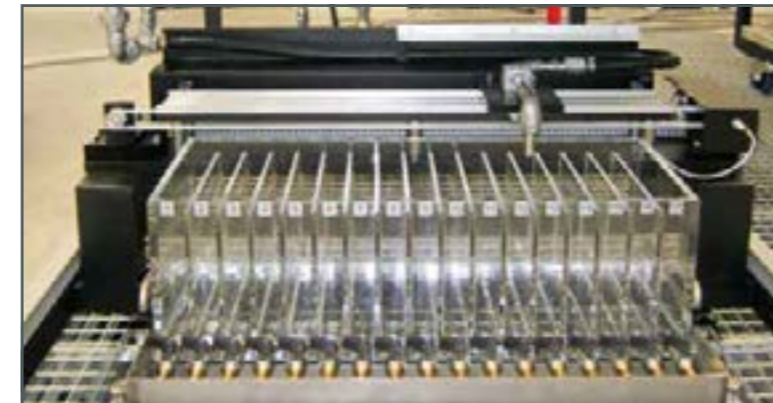
Las cámaras de medición se llenan sucesivamente de forma temporizada.
