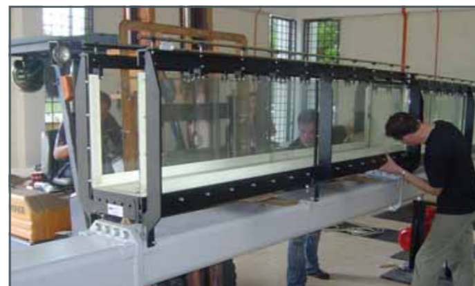
El elemento de la sección de ensayo es colocado sobre el elemento portador con una carretilla de horquilla elevadora, orientado y montado.
