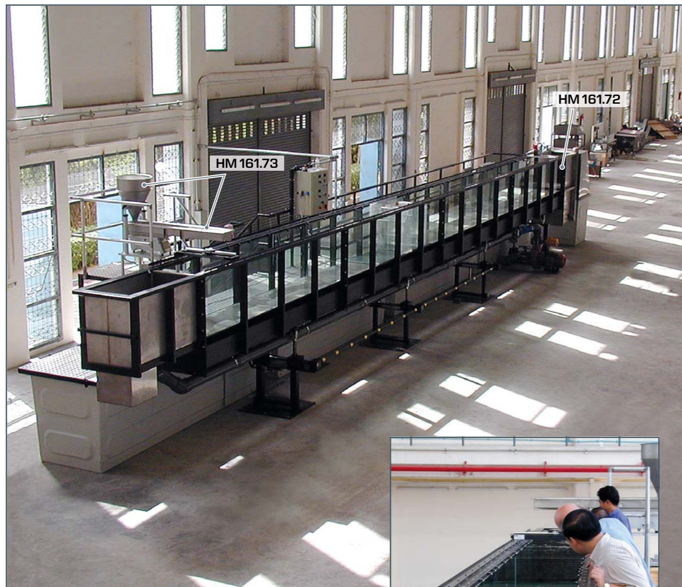
Canal de ensayo HM 161 con transporte de sedimentos. El alimentador de sedimentos HM 161.73 está colocado sobre el elemento de entrada. Al final de la sección de ensayo hay la trampa de sedimentos HM 161.72 para separar los sedimentos.
