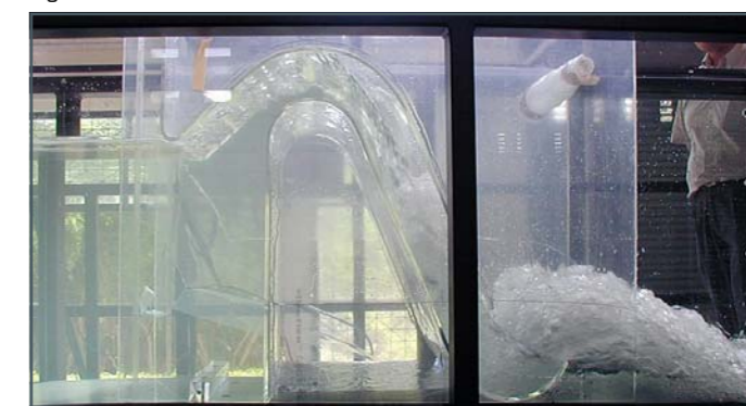
Descarga en el vertedero de sifón HM 161.36 en funcionamiento
