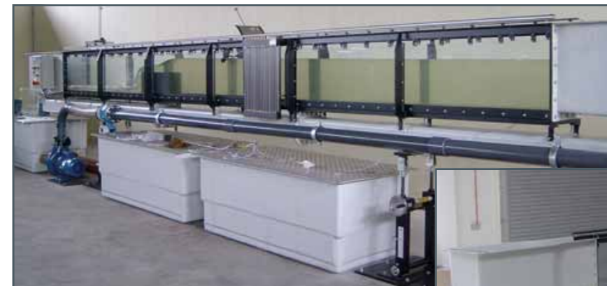
Una vez finalizado el montaje, se realiza la puesta en funcionamiento. La foto muestra el funcionamiento de un vertedero de cresta ancha.
