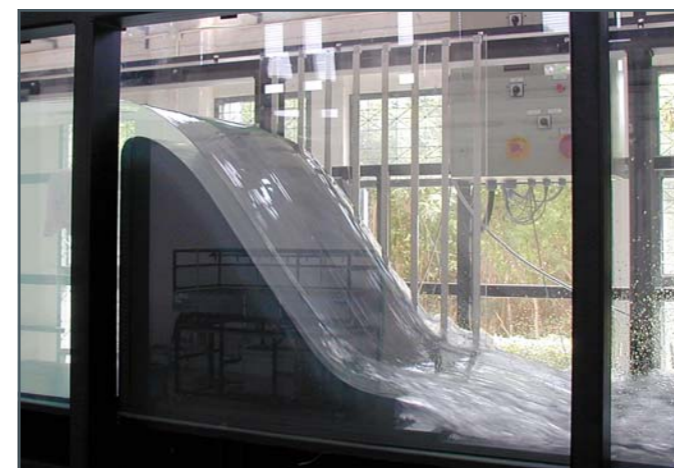
Vista lateral en la descarga sobre la presa-vertedero de perfil Ogee HM 161.34
