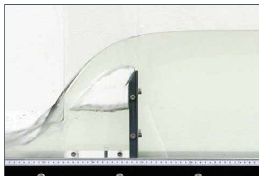
Vertedero de cresta delgada aireada (vista lateral)
