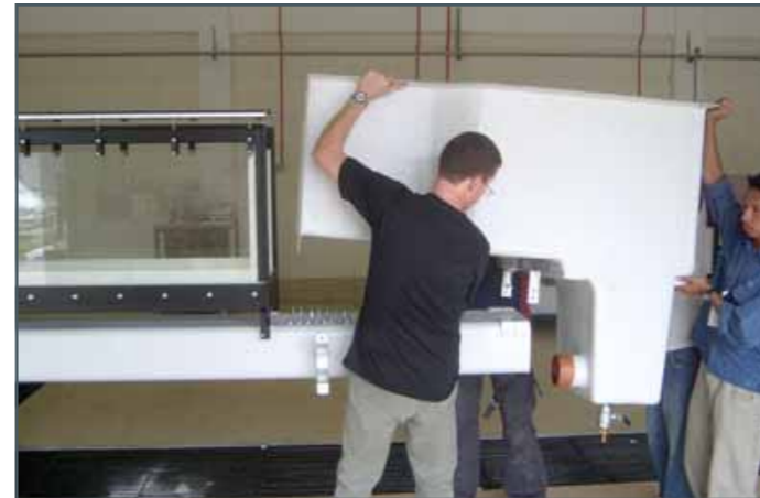
El elemento de entrada se eleva al elemento portador, se orienta y se conecta a la sección de ensayo.
