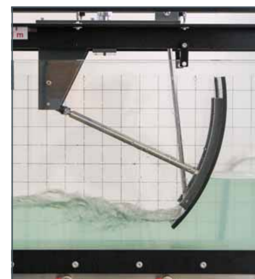
Compuerta de segmento
