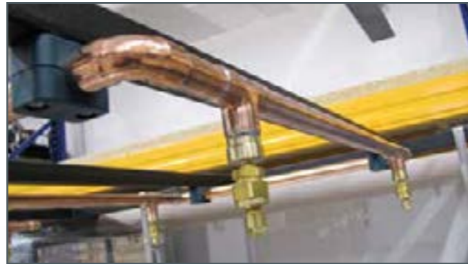
Dispositivo de precipitación con toberas para una simulación realista de las precipitaciones
