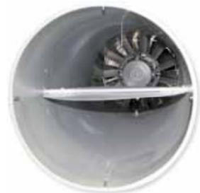
Válvula de mariposa al final de la sección de medida para ajustar el flujo volumétrico.
