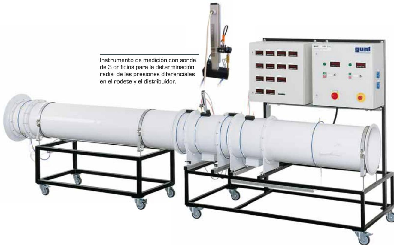
Instrumento de medición con sonda de 3 orificios para la determinación radial de las presiones diferenciales en el rodete y el distribuidor.
