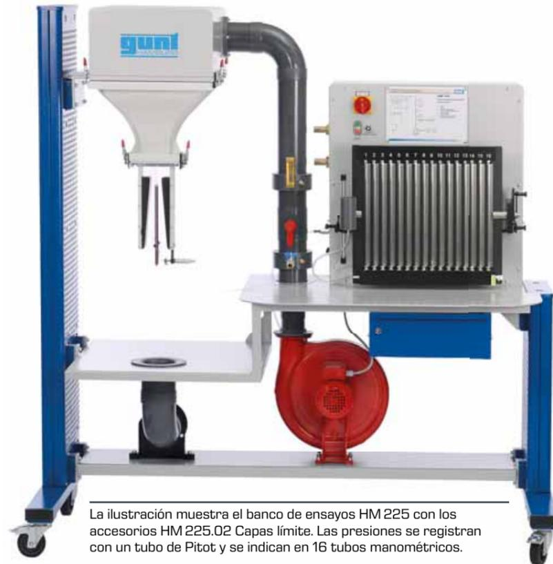
La ilustración muestra el banco de ensayos HM 225 con los accesorios HM 225.02 Capas límite. Las presiones se registran con un tubo de Pitot y se indican en 16 tubos manométricos.
