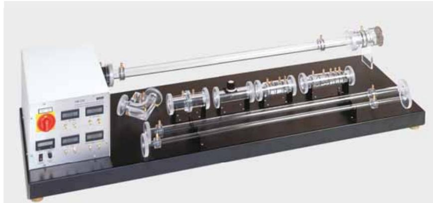
El amplio programa de ensayos del banco HM 230 permite transmitir de manera ideal los fundamentos de los flujos compresibles. A través de una gran variedad de ensayos, los estudiantes adquirirán amplios conocimientos y una profunda comprensión del flujo de fluidos compresibles. Una tobera especialmente concebida para el rango supersónico permite introducir la temática de los flujos transónicos.
