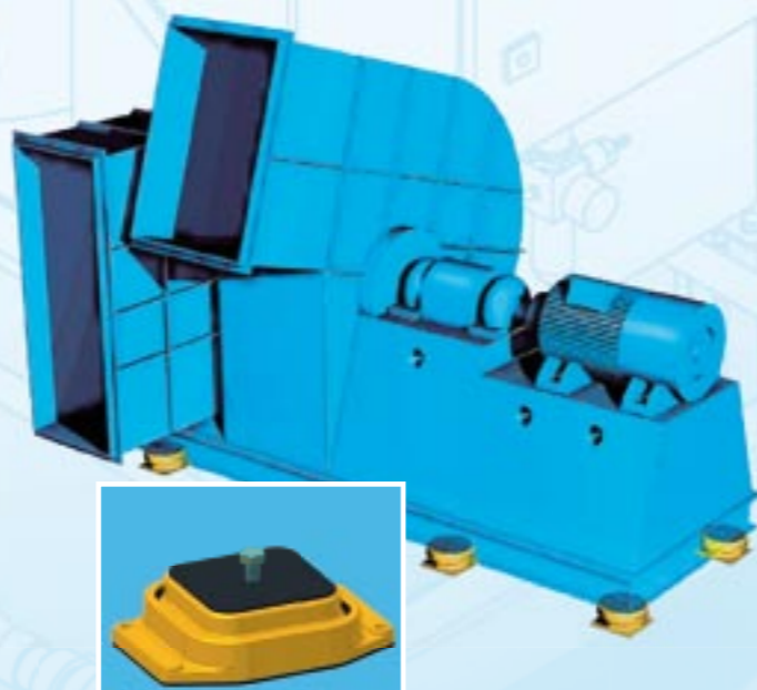
Aislamiento antivibraciones con elementos de resorte de elastómero Fuente: www.ruheschutz.ch , www.gerb.com
