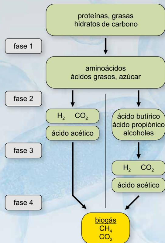
Principio básico de la degradación anaerobia
