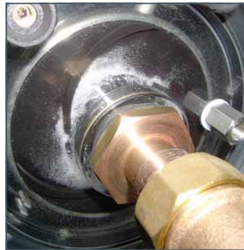
Formación de burbujas de vapor por cavitación en un rodete de la bomba (HM 380)
