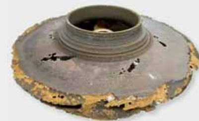
Rodete de la bomba destruido por la erosión de cavitación
