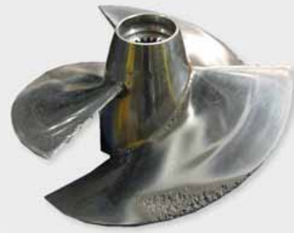
Hélice de barco destruida por la erosión de cavitación
