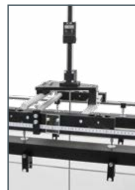
Indicador del nivel de agua digital HM 162.91 con portainstrumentos
