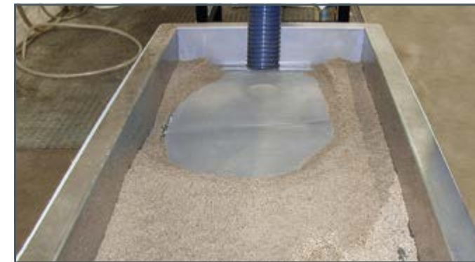
Trampa de sedimentos HM 160.72 en el depósito de agua de HM 160 para recoger los sedimentos
