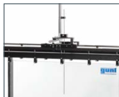
Indicador del nivel de agua HM 162.52 con portainstrumentos
