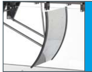
HM 162.40 Compuerta de segmento
