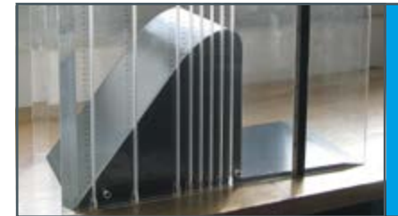
HM 162.34 Presa-vertedero de perfil Ogee con medición de la presión
