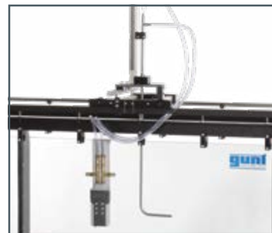
Tubo de Pitot estático HM 162.50 con portainstrumentos
