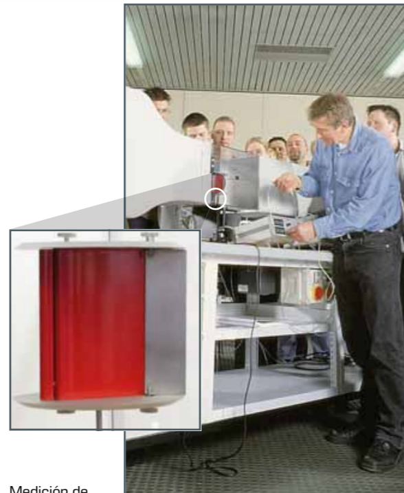
Medición de fuerzas de sustentación y resistencia aerodinámica en función del ángulo de ataque en una superficie sustentadora con slat y flap de intradós
