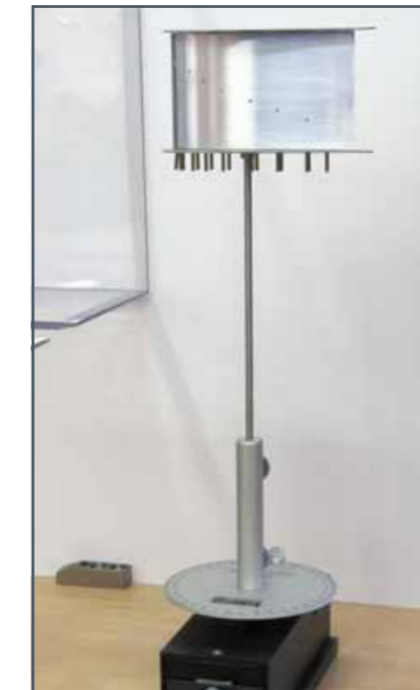
Distribución de la presión en una superficie sustentadora expuesta a flujos de aire alrededores
