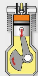
La mezcla comprimida de combustible y aire se enciende poco antes de que se alcance el punto muerto superior. La presión generada presiona el émbolo hacia abajo.
