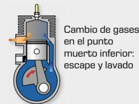
**Procesos debajo del émbolo:** la mezcla aspirada se precomprime mediante el descenso del émbolo y se presiona a la lumbrera de transferencia. La sobrepresión cierra la válvula de admisión.
