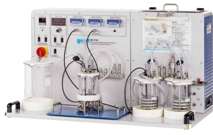
Unidad de alimentación para los reactores químicos CE 310 con los Reactores continuos de mezcla perfecta en Serie CE 310.03
