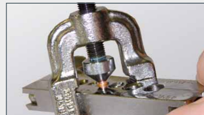
Rebordeado de la tubería con la herramienta de rebordeado
