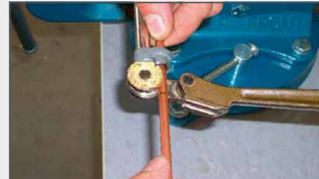
Colocación de la tubería en la instalación de curvado
