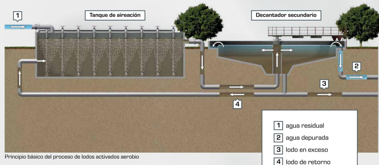
Principio básico del proceso de lodos activados aerobio
