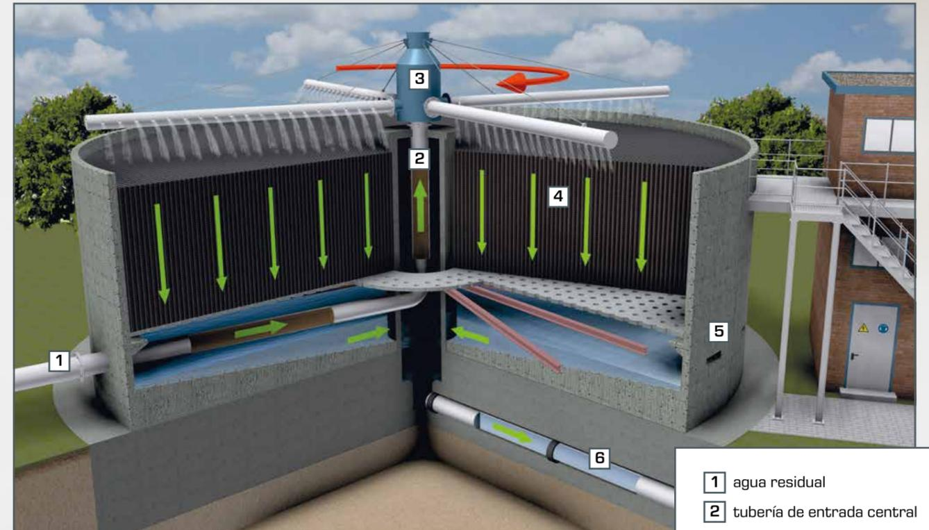
Diseño y funcionamiento de un filtro percolador
