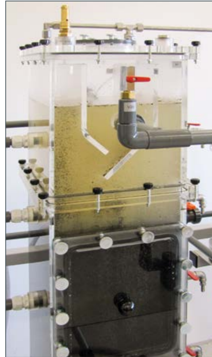
Reactor UASB del CE 702 durante el funcionamiento de prueba con éxito en nuestro laboratorio
