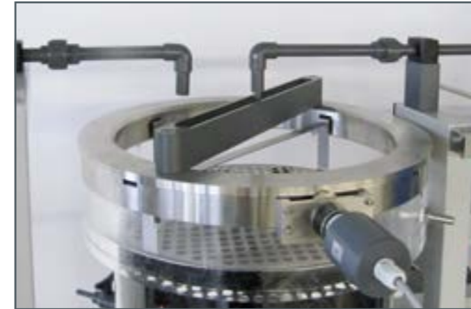
Rociador rotativo en la cabeza del filtro percolador con ajuste de número de revoluciones sin escalonamiento
