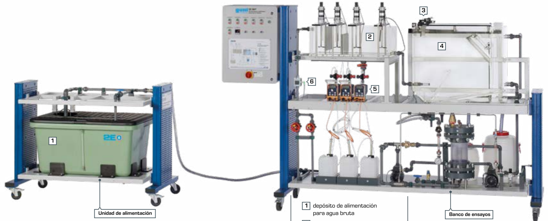
Al igual que en las plantas de flotación de las instalaciones industriales, el CE 587 está equipado con un rascador eléctrico que elimina las materias sólidas flotantes de la superficie del agua.
