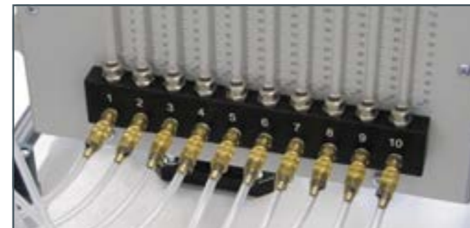
Conexiones en el panel de manómetros para medir la presión en el lecho filtrante
